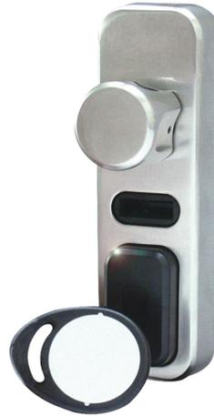
Este robusto y fiable cilindro es sinónimo de seguridad, control y comodidad de acceso. Ha sido desarrollado especialmente para su uso en puertas antipánico con restablecimiento automático de los paletones de cierre. Se maneja a través de la llave de chip protegida contra lectura ABUS Seccor. El cilindro dispone de blindaje adicional para una protección aún mayor en intentos de allanamiento.
