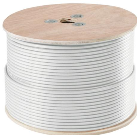
Le câble vidéo combiné relie les différents composants entre eux et assure une bonne transmission des données. Les deux câbles électriques intégrés (2x 0,75mm<sup>2</sup>) alimentent en courant les appareils raccordés. La résistance des câbles s'élève à 75 ohms. Le câble coaxial existe dans des longueurs de 50 mètres (KA9002), 100 mètres (KA9001) et 250 mètres (KA9000).
