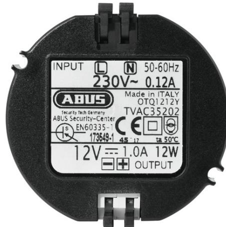
Das stabilisierte Mini-Clip-Einbaunetzteil (230 V AC / 12 V DC, 1 A) dient der Spannungsversorgung Ihrer Videokomponenten. Die Weiterentwicklung mit einer Hebel-Federklemme macht die schnelle Installation ohne Werkzeug oder zusätzliche Klemme möglich. Mit seinen kompakten Maßen eignet es sich besonders gut als Unterputznetzteil zum Einbau in eine 55 mm Unterputzdosen und überall dort, wo wenig Platz für die Stromversorgung vorhanden ist.
