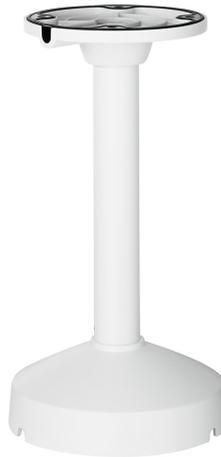
Pour un câblage protégé à l'intérieur et à l'extérieur, le boîtier d'installation permet de fixer les caméras Hemispheric à un plafond de manière professionnelle. Grâce au support de plafond composé de deux barres en aluminium de 23 cm de long, le boîtier d'installation peut être suspendu au choix à 23 ou 46 cm du plafond.
